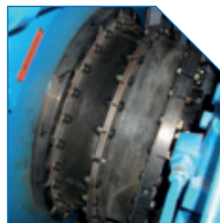
Kupplung TEF 641W-RR im Hauptantrieb eines Cargo- Binnenschiffes. 1104 kW bei 800 r.p.m. (Motor ABC- Diesel)
