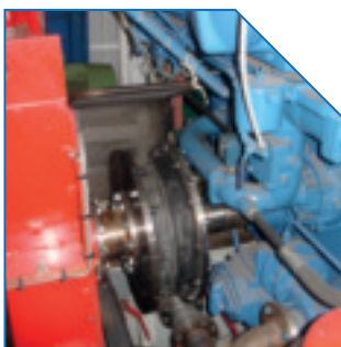
Die Kupplung TEF 523 W-RR verbindet die Feuerlöschpumpe mit dem PTO- Antrieb des Dieselmotors. 675 kW bei 1000 r.p.m. (Schiff = Schlepper GINGER, Motor = ABC- Diesel, Type 12 DZC)
